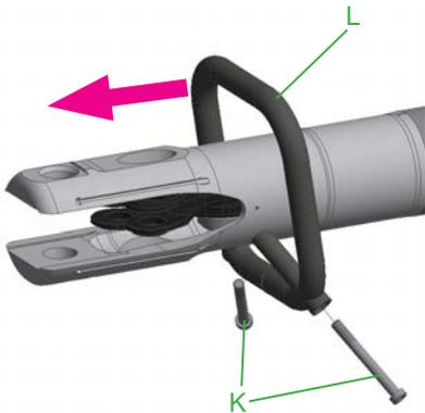
6. Lösen Sie die Befestigungsschrauben "K" und entfernen Sie diese. Jetzt kann der Handgriff "L" nach vorne abgezogen werden.
