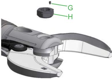
4. Demontieren Sie zuerst die Stiftschraube "G", dann die Zentralbolzenmutter "H" und ziehen Sie anschließend den Zentralbolzen "J" heraus.
