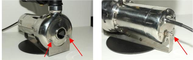
8. Stellen Sie die Pumpe senkrecht hin und entfernen nun alle 6 Zylinderkopfschrauben mit Innensechskant M5 (also jede zweite Schraube) am Spiralgehäuse der Pumpe. Die 6 Torx-Sicherheitsschrauben sind nicht zu öffnen, da sie den Motor zusammenhalten.
