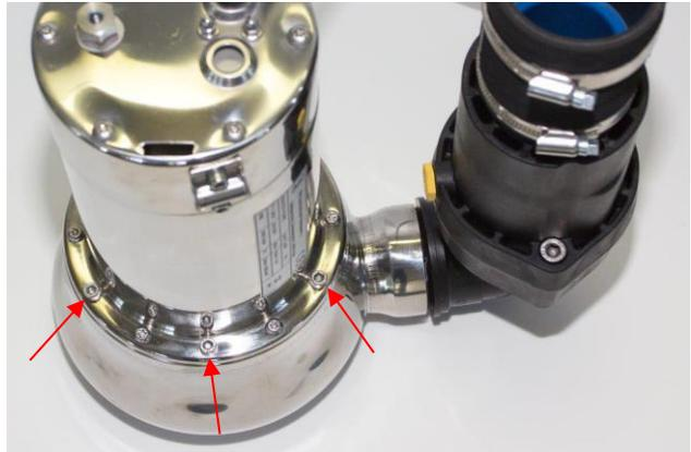
9. Ziehen Sie nun den Motor vom Spiralgehäuse ab, reinigen das Spiralgehäuse und Laufrad und überprüfen die Leichtgängigkeit des Laufrads.
