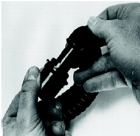
**Bild 16** Verbindungsstück in die unterste Falte des Atemschlauches einknöpfen.
