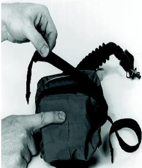
**Bild 23** Gefalteten Atembeutel festhalten und das lange Ende des Leibgurtes 1 x um das Gerät wickeln und fest anziehen.
