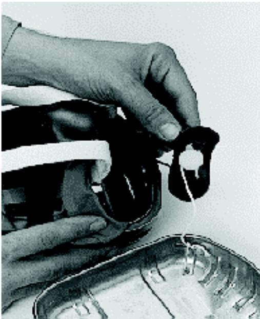
**Bild 26** Stopfen in die Mundstücksöffnung stecken. Mundstück neben der Nasenklemme im freien Raum am Behälterrand unterbringen.
