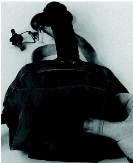
**Bild 22** Unteres Ende des Atembeutels 2x nach oben klappen (Ventil unter Kanisterboden).
