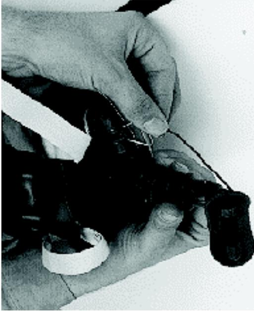
**Bild 25** Atemschauch zusammenschieben und teilweise in den freien Raum zwischen Gerät und Behälterrand stecken.
