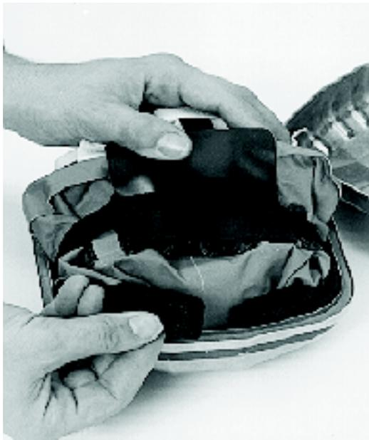
**Bild 28** Das kurze Ende des Leibgurtes zusammenfalten und neben das Ventil in den Behälter stecken. Mit dem restlichen Teil des langen Endes ebenso verfahren.
