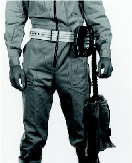
**Bild 3** Falls Behälteroberteil und Verschuß beim Öffnen zusammen abfallen, entfaltet sich das Gerät und hängt am Mundstückstopfen. Gerät vom Stopfen abziehen.
