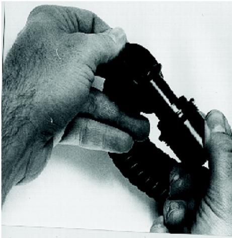
**Bild 11** Verbindungsstück aus Atemschlauch ausknöpfen.
