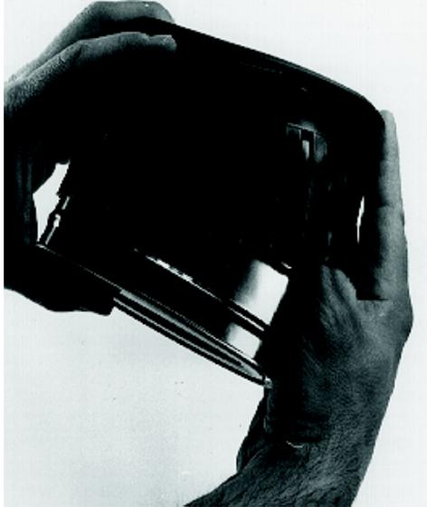
**Bild 15** Kanister in die Kanisterhülle bis zum Anschlag einschieben.
