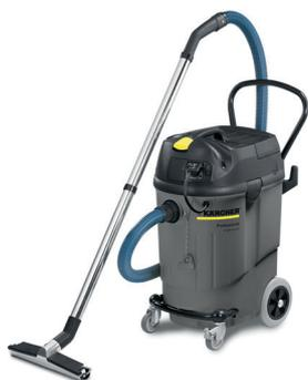
Nass- und Trockensauger zum kontinuierlichen Absaugen und Entsorgen von Schmutzwasser. 55 Liter Kunststoffbehälter, zwei Bockräder, zwei Stopp-/Lenkrollen, Schubbügel. Entnehmbare Entsorgungspumpe, mechanisches Doppelschwimmersystem für rechtzeitiges Unterbrechen bei Erreichen des Maximalfüllstandes, Grobschmutzfilter, Pumpenabgang Kupplung Storz C mit Absperrhahn
