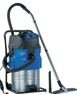
Nass- und Trockensauger zum kontinuierlichen Absaugen und Entsorgen von Schmutzwasser. 70 Liter Edelstahlbehälter, automatische Entleerung. Zwei Transporträder, Schubbügel, Grobschmutzfilter. Integrierte Tauchpumpe, Filtereinsatz aus Edelstahl, Pumpenabgang Kupplung Storz C
