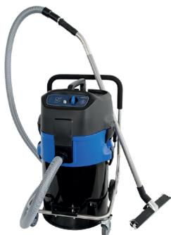
Hochwasser- und Schlammstauger zum kontinuierlichen Absaugen und Entsorgen von mit Schlamm, Steinen und sonstigen Fest- und Schwebstoffen grob verunreinigtem Wasser. 80 Liter PE-HD-Behälter, LED-Füllstandsanzeige, elektronische Niveauerfassung mit automatischer Entleerung. Zwei Bockräder, zwei Stopp-/Lenkrollen, Schubbügel. Motorgehäuse aus Edelstahl. Zweikanalrad-Schmutzwasserpumpe für verstopfungsfreien Permanentbetrieb, Korndurchgang 50 mm, Pumpenabgang Kupplung Storz C
