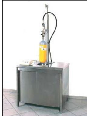
**Bild 7:** Die Water-Jacket-Prüfanlage WJ 199 dient der Druckprüfung von Composite-Druckgasflaschen. Es wird das Messprinzip der volumetrischen Ausdehnung angewandt.
