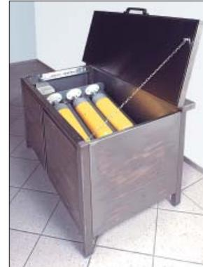
**Bild 8:** Mit dem Rolliergerät können gleichzeitig bis zu 3 Druckgasflaschen innen gereinigt werden. Zur Geräuschdämpfung ist es in einem Edelstahlgehäuse gekapselt.
