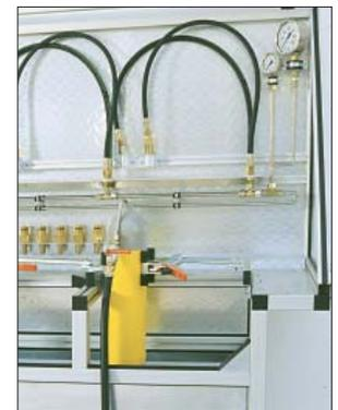
**Bild 5:** Atemluftflasche in der Schnellspannvorrichtung. Darüber: die zwei HD-Schlauchanschlüsse für 500 bzw. 60 bar maximaler Prüfdruck. Rechts: die beiden Prüfmanometer zum Ablesen des Prüfdruckes.
