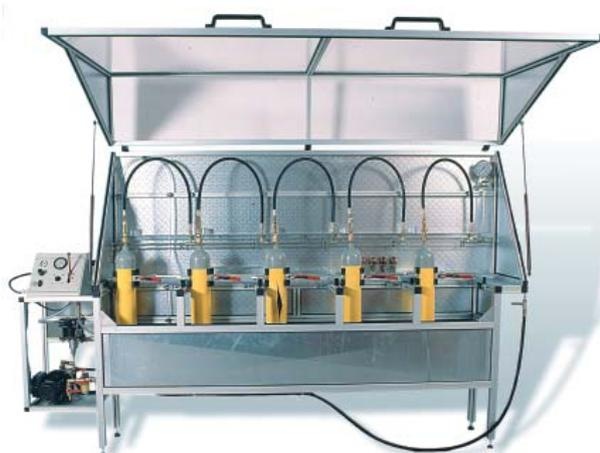
**Bild 1: Mit dem Hydrotestgerät HTG 500 können Stahl- oder Alu-Druckgasflaschen mit einem regelbaren Prüfdruck von bis zu 500 bar geprüft werden. Die Anlage gewährleistet einen höchstmöglichen Personenschutz, weil die Wasserdruckprüfung im Berstfall nur wenig Volumen zur Druckentlastung freisetzt und außerdem eine bruchsichere Makrolonhaube zusätzlich schützt.**
