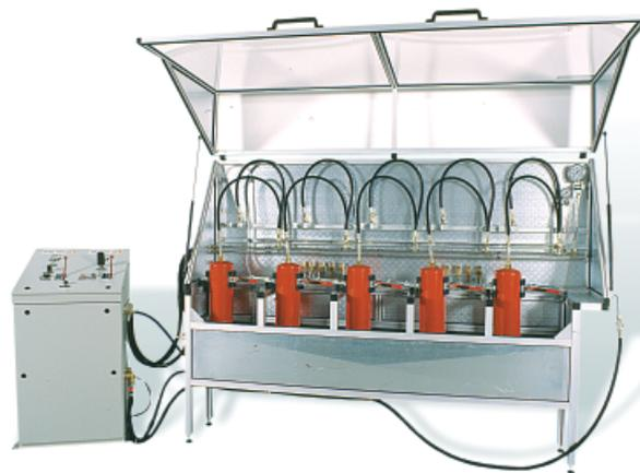
Auch der Prüfstand enthält an jedem der 5 Arbeitsplätze jeweils 2 unverwechselbare HD-Schlauchverbindungen zu den Druckbehältern.
