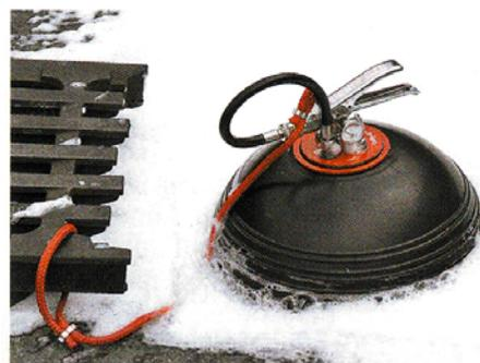
Das Gully-Ei besitzt einen innen liegenden Luftbehälter, aus dem die Gummiblase gefüllt wird. Dadurch lassen sich Einläufe sekunden-schnell abdichten.
